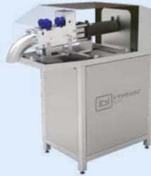
Der Edelstahlschrank ist so konstruiert, dass er leicht mit einem Gabelstapler bewegt werden kann, was eine regelmäßige, einfache Reinigung um und unter der Maschine ermöglicht. Größere abnehmbare Paneele ermöglichen einen klaren und geräumigen Zugang zu allen Komponenten im Inneren des Granulators und machen die routinemäßige Wartung zeit- und kosteneffizient.
