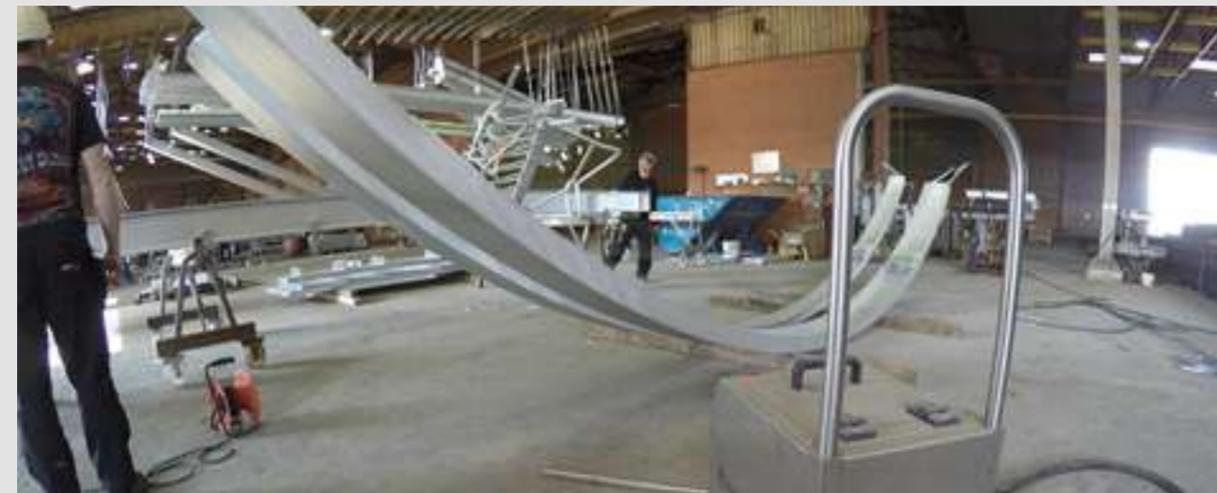
Die Entfernung von Flecken mit Zinkasche ist in Sekundenschnelle erledigt, ohne dass die Oberfläche beschädigt wird. Wir liefern mobile Geräte, die an mehreren Stellen eingesetzt werden können, wo sich Standard-Druckluftanschlüsse befinden.
