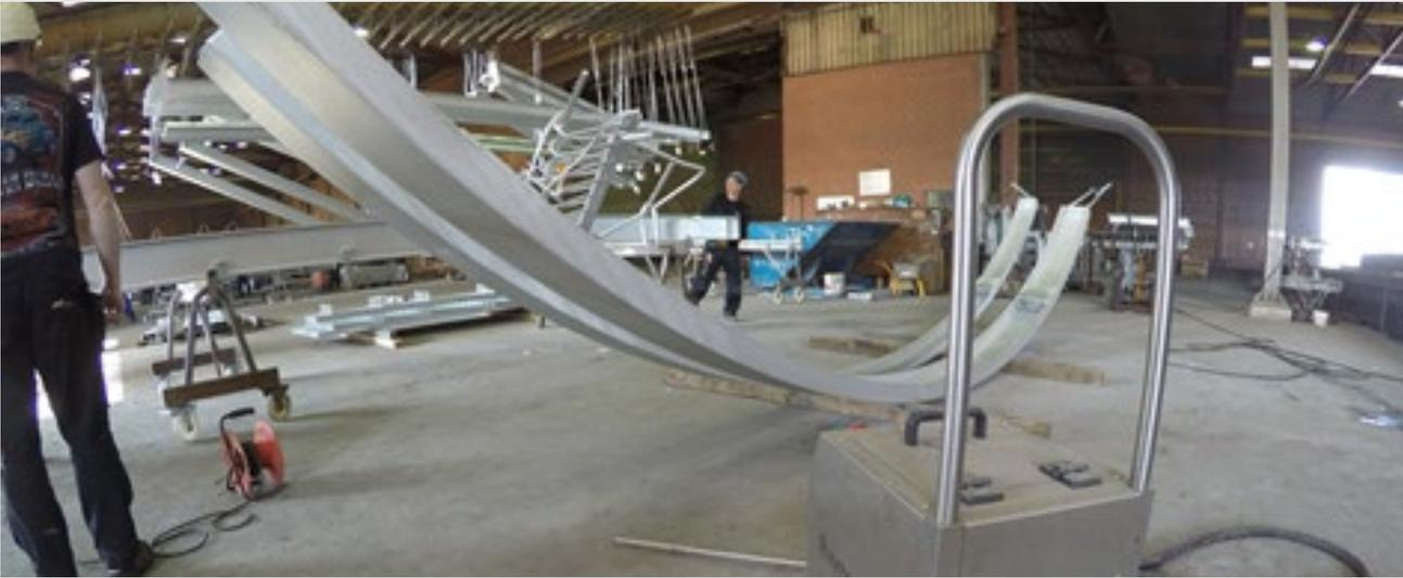
La eliminación de manchas con cenizas de zinc se realiza en segundos sin dañar la superficie.
