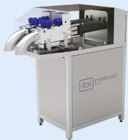
El gabinete de acero inoxidable está diseñado para poder ser desplazado fácilmente con un montacargas, lo que facilita la limpieza regular y sencilla alrededor y debajo de la máquina. Los paneles removibles más grandes permiten un acceso claro y amplio a todos los componentes internos de la pelletizadora, haciendo que el mantenimiento rutinario sea rápido y económico.
