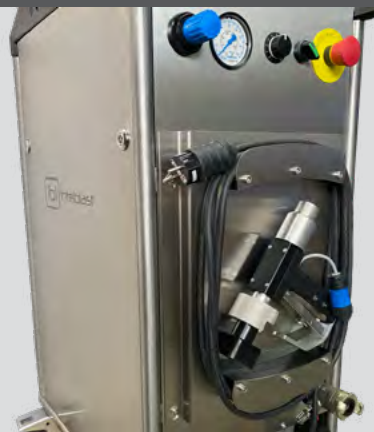
Supporto per pistola e cavo elettrico
